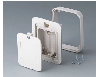
A9336117 Батарейный отсек, 3 x AA АБС (UL 94 HB) белый RAL 9002 93x69mm IP 54
