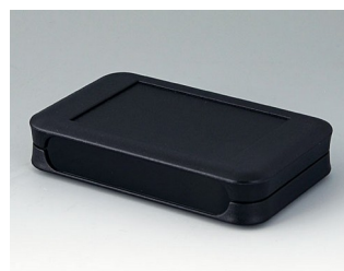
A9052209 SOFT-CASE L ПММА (ИК) (UL 94 HB) черный RAL 9005 73x117x24mm IP 54 opt., IP 40
