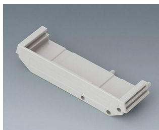
B6724334 Концевая деталь монтажного основания RAILTEC, 72 ПА 6 (30) (UL 94 V-0) светло-серый 82x22,2x16mm
