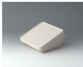
B4414307 PROTEC 140, исп. III АСА+ПК-ФР (UL 94 V-0) белый RAL 9002 140x160x76mm IP 65 opt.
