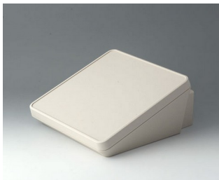
B4422307 PROTEC 220, исп. III АСА+ПК (UL 94 V-0) белый RAL 9002 220x243x108mm IP 65 opt.
