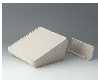
B4418207 PROTEC 180, исп. II АСА+ПК-ФР (UL 94 V-0) белый RAL 9002 180x180x92mm IP 65 opt.
