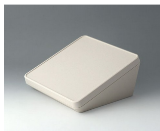
B4422107 PROTEC 220, исп. I АСА+ПК-ФР (UL 94 V-0) белый RAL 9002 220x220x108mm IP 65 opt.
