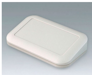
A9446107 EVOTEC 150, исп. III АСА+ПК (UL 94 V-0) белый RAL 9002 150x93x36mm IP 65 opt., IP 40
