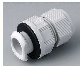
C2320717 Кабельный ввод для быстрой установки, M20 ПА 6 светло-серый RAL 7035
