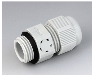
C2316917 Кабельный ввод M16x1,5, с компенсацией давления ПА 6 (UL 94 V-0) светло-серый RAL 7035 IP 68
