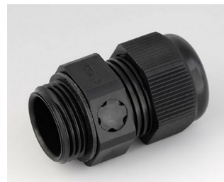
C2320919 Кабельный ввод M20x1,5, с компенсацией давления ПА 6 (UL 94 V-0) черный RAL 9005
