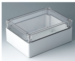
C7021074 IN-BOX АБС/ПК (UL 94 HB) светло-серый RAL 7035 202x152x90mm IP 66, IP 67, IK 07
