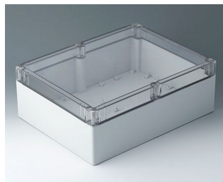
C7030115 IN-BOX ПК светло-серый RAL 7035 302x232x110mm IP 66, IP 67, IK 08
