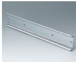
C7115077 DIN-рейка TH 35 Сталь 184x35x7,5mm
