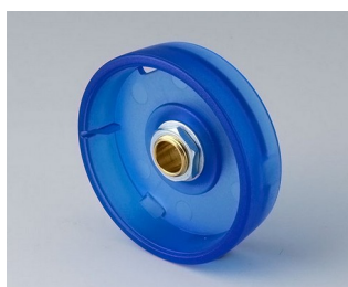
B8241066 Ручка STAR-KNOB 41 ПК (UL 94 HB) сапфировый 41x14mm 6mm
