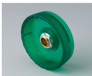
B8341065 Ручка STAR-KNOB 41, с выступами ПК (UL 94 HB) изумрудный 41x14mm 6mm
