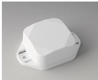
V1802227 MINI-DATA-BOX SF40, высокий, с ушками АСА+ПК (UL 94 V-0) белый RAL 9016 40x40x20mm IP 65 opt., IP 40
