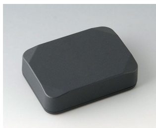
B1824218 MINI-DATA-BOX E50, высокий АСА+ПК (UL 94 V-0) тёмно-серый RAL 7016 70x50x20mm IP 65 opt., IP 40
